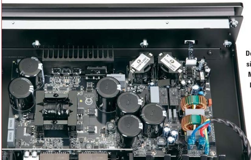
Der Innenaufbau ist übersichtlich und mit jeder Menge SMD-Bauteilen bestückt. Die Spulen finden sich zwecks Filterung in allen Class-D-Verstärkern.
